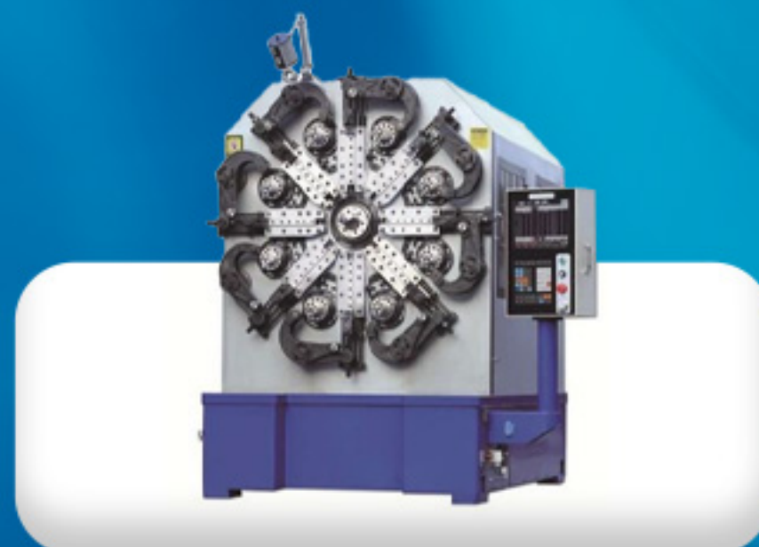
Máquina CNC 0,30 a 2,30mm Molas de tração, torção e artefatos
