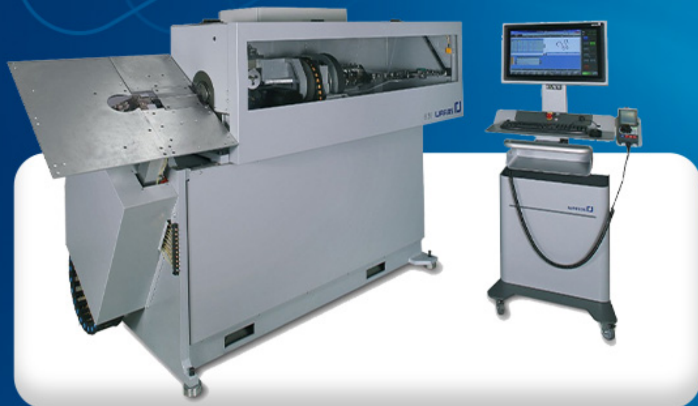
Máquina Wafios Modelo B36 Produção de artefatos de arame
